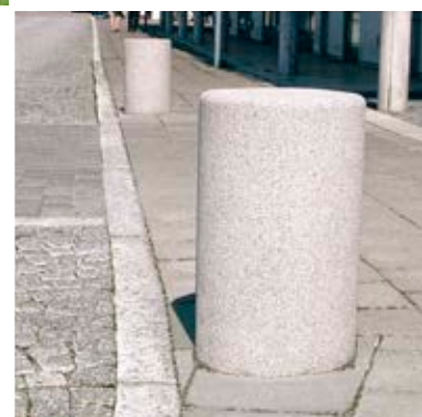
Cylinderformad stolpe av Grå Bjärlövsgranit, krysshamrad
